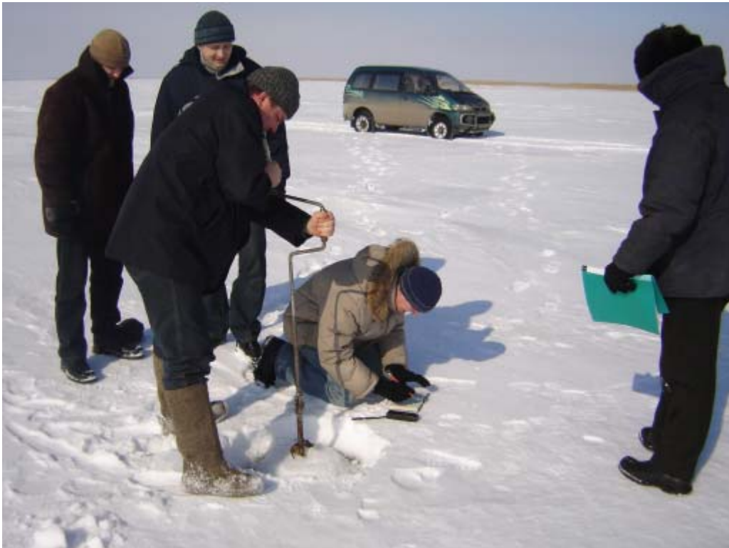
Рис.5. Бурение лунки во льду в точке отбора проб донных отложений. Накопитель Балкылдак, март 2006 г.
