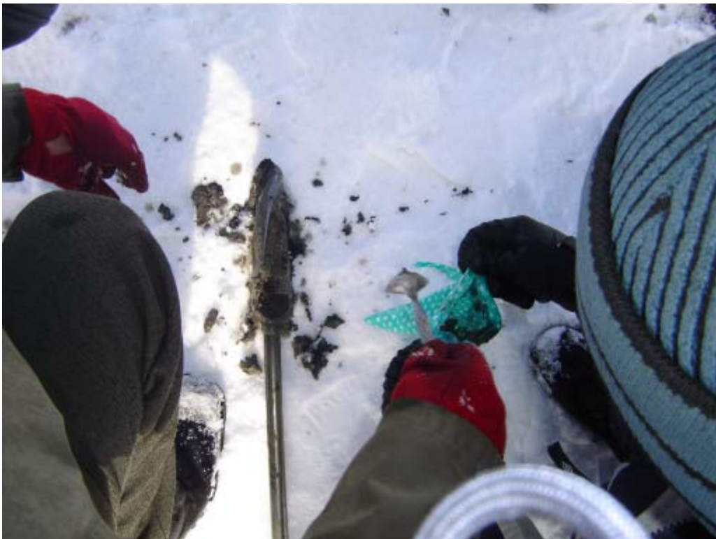
Рис.8. Пробоотборник для отбора плотных глинистых отложений. Накопитель Балкылдак, март 2006 г.
