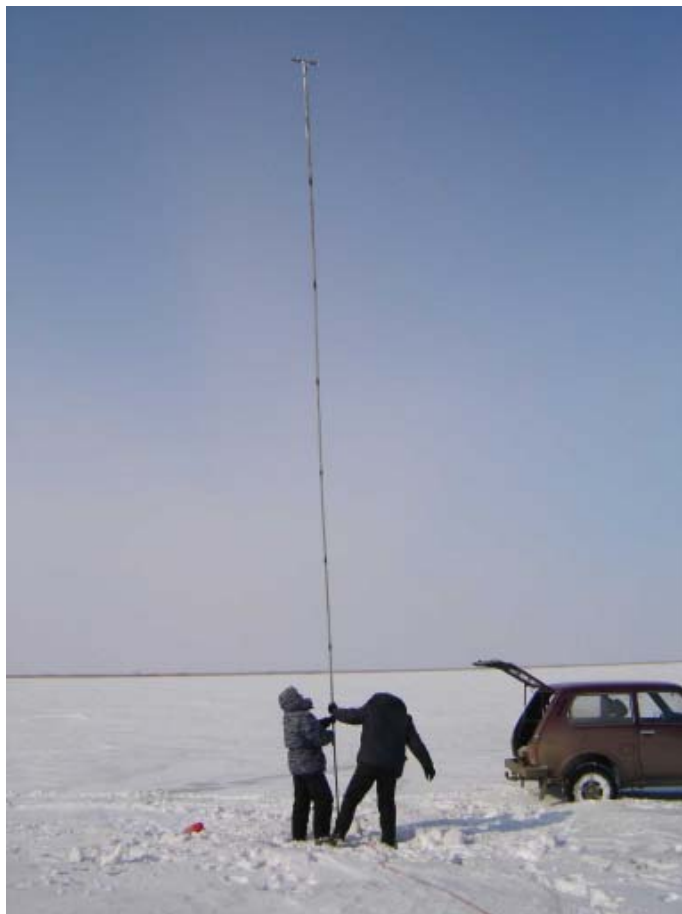
Рис.6. Отбор пробы донных отложений с глубины 9 м. Накопитель Балкылдак, март 2006 г.
