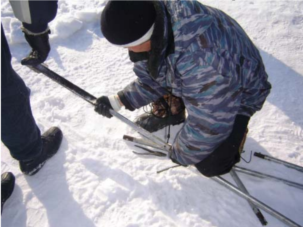
Рис.7. Пробоотборник для послойного отбора керна мягких илов. Накопитель Балкылдак, март 2006 г.
