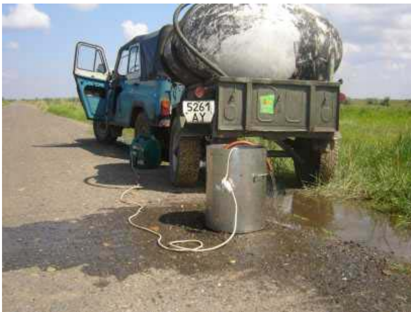
Рис. 5. Промывка оборудования после отбора проб подземных вод
