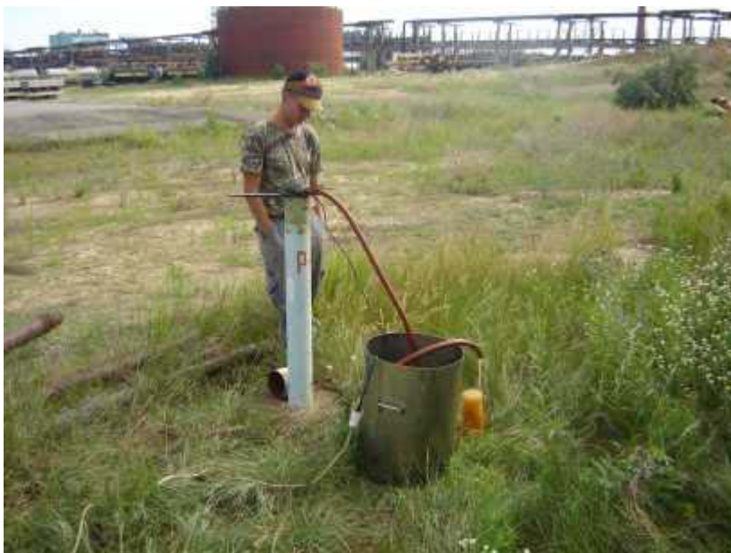
Рис. 2 Откачка подземной воды из наблюдательной скважины
