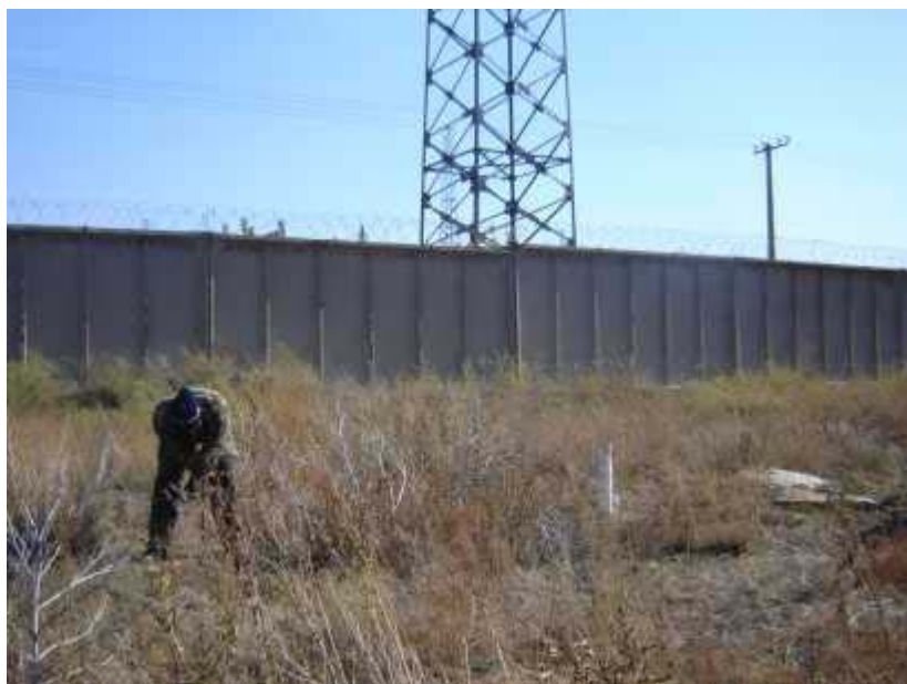
Рис. 12. Бурение первой разведочной скважины для исследования распространения загрязнения нефтепродуктов вблизи промплощадки ПНХЗ
