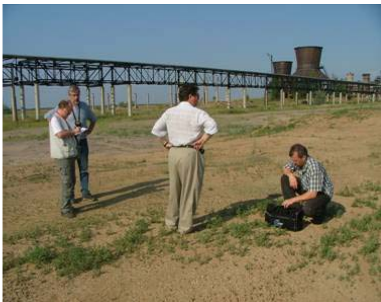
Рис. 8. Измерение концентрации паров ртути в приземном слое воздуха на промплощадке хлор-щелочного производства (на месте корпуса 34)
