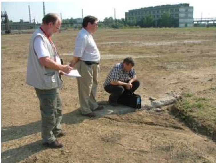
Рис. 7. Измерение концентрации паров ртути в приземном слое воздуха на промплощадке хлор-щелочного производства (на месте корпуса 31)
