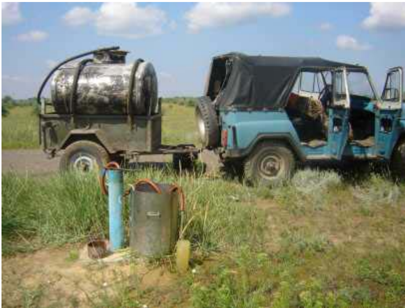
Рис. 3. Откачка подземной воды из наблюдательной скважины
