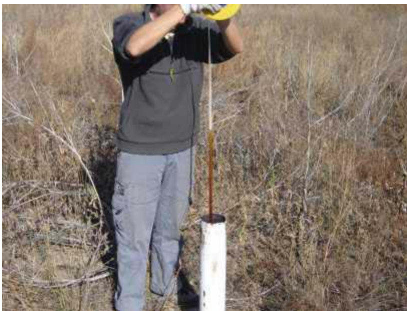
Рис. 13. Загрязнение нефтепродуктами наблюдательной гидрогеологической скважины №54
